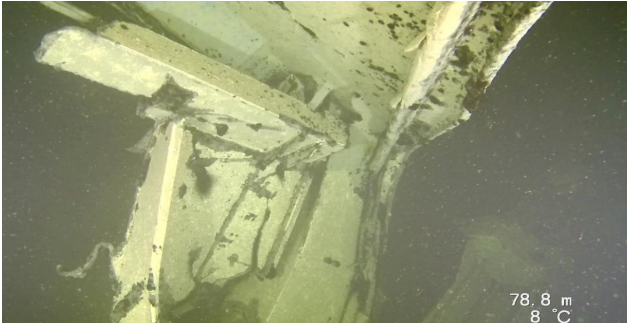
Rampens nedre styrbords hörn sitter fortfarande fäst med intakt gångjärn inne i rampöppningen och är inte sönderrostad. Bild från SHK:s undersökning i juli 2021.
